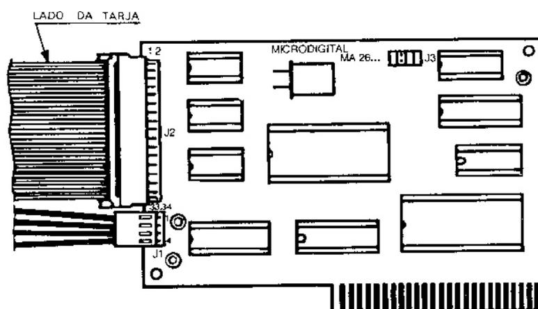
4. Introduzir o conector plástico de 4 pinos, presente numa das extremidades do cabo de alimentação, no conector J1 da placa. Verificar se os pinos estão alinhados e instalar o cabo conforme indica a figura 1.
